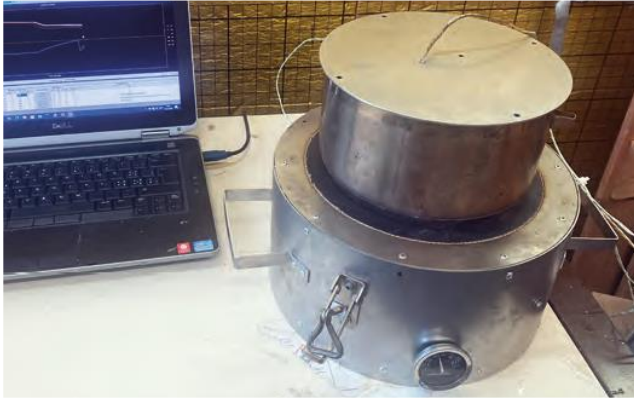
Die Leistung unseres Prototyps eines thermischen Wärmespeichers wird gemessen.
