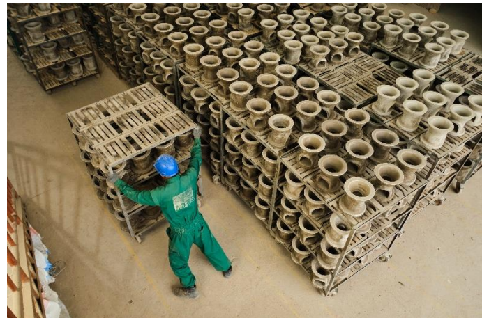
Tonkörper für Kocher vortrocknen, bevor sie gebrannt werden
